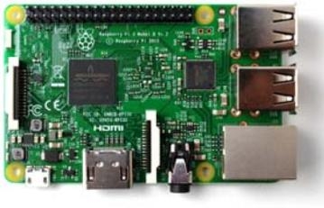
Fig. 2. Raspberry Pi 3 Model B
